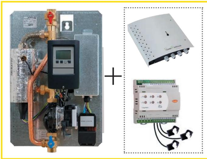
Die elektrothermischen Stationen wandeln überschüssigen Strom aus einer Photovoltaikanlage in Wärme um. Dies wird durch ein externes Energiemanagement-System gemessen und geregelt. Dabei sorgt die Schichtbeladung des Speichers für eine optimale Bevorratung und Nutzung der Energie.
