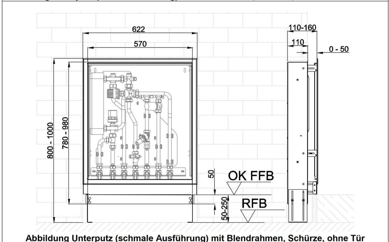
**Abbildung Unterputz (schmale Ausführung) mit Blendrahmen, Schürze, ohne Tür**
